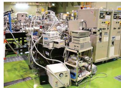
時間相関スペックル実験装置写真(全体図) X線ストリークカメラ計測時間幅: 500ピコ秒/10ピコ秒
